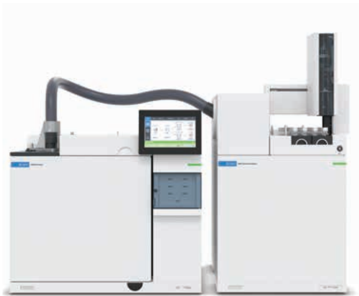
ГХ Agilent 8890, подключенный к парофазному пробоотборнику 8697, обеспечивает бескомпромиссную универсальность для самых требовательных лабораторий.
