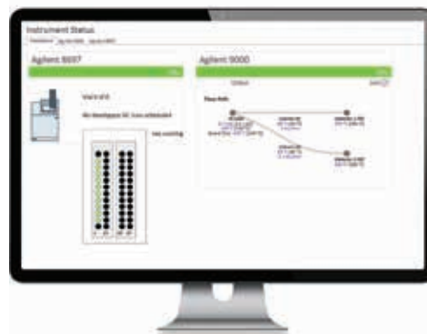
Панель управления Agilent OpenLab позволяет одним взглядом получить информацию о состоянии анализа, типе образца и выполняемой операции для каждой из виал, а также узнать, какие виалы сейчас находятся в термостате.
